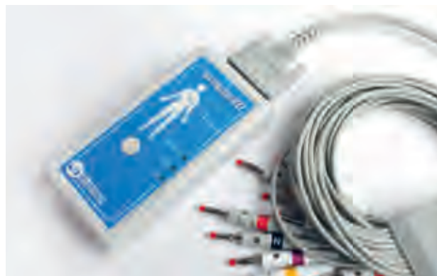
«Поли-Спектр-8/ЕХ» — беспроводной миниатюрный электрокардиограф
